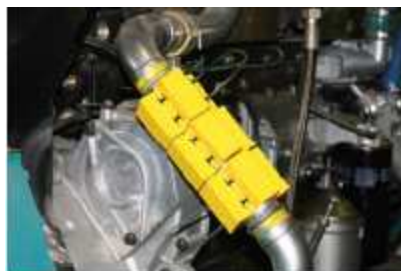
Economiseur de combustible installé sur un moteur à explosion.
